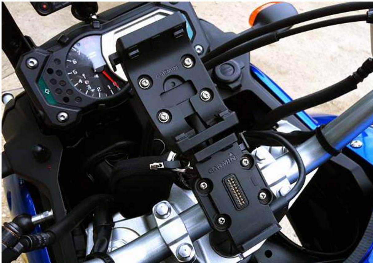
De voedingskabel is makkelijk van de cradle te verwijderen. De rubberen afdichting v.d. contacten kan mooi in de houder gestoken worden.
