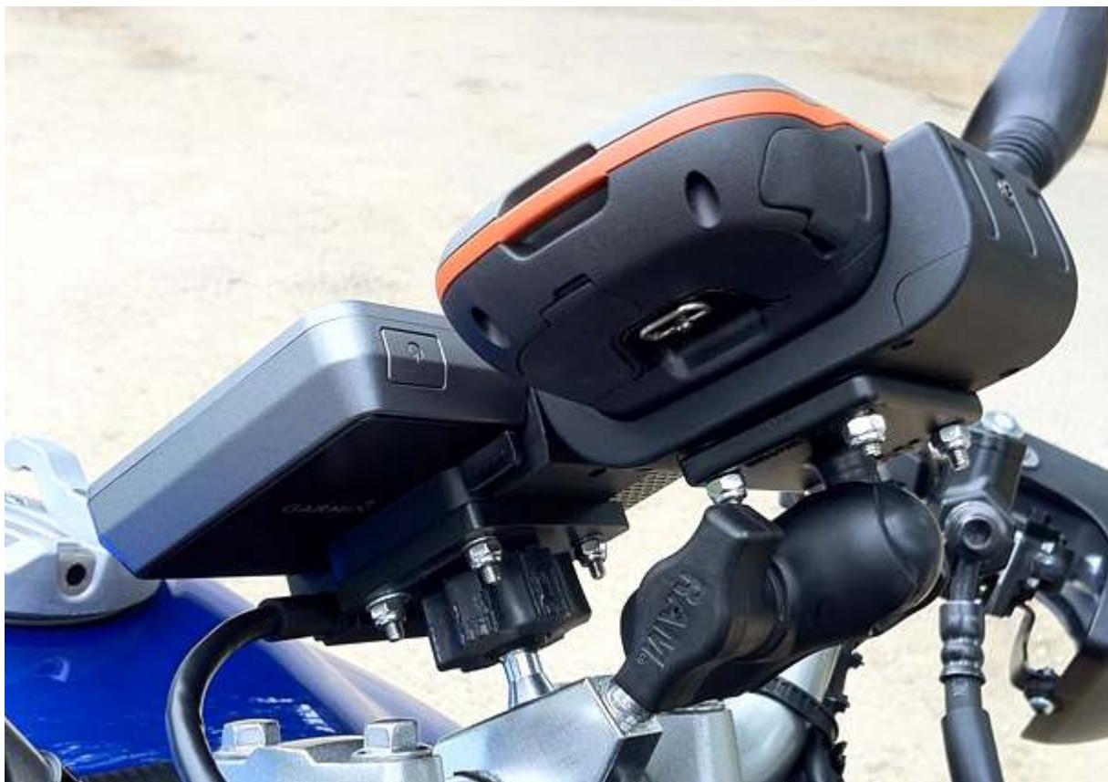
De cradle is robuuster dan die van de Zumo 660 en vergrendelbaar met Zumo schroefje, net zoals destijds op de Zumo 550.
