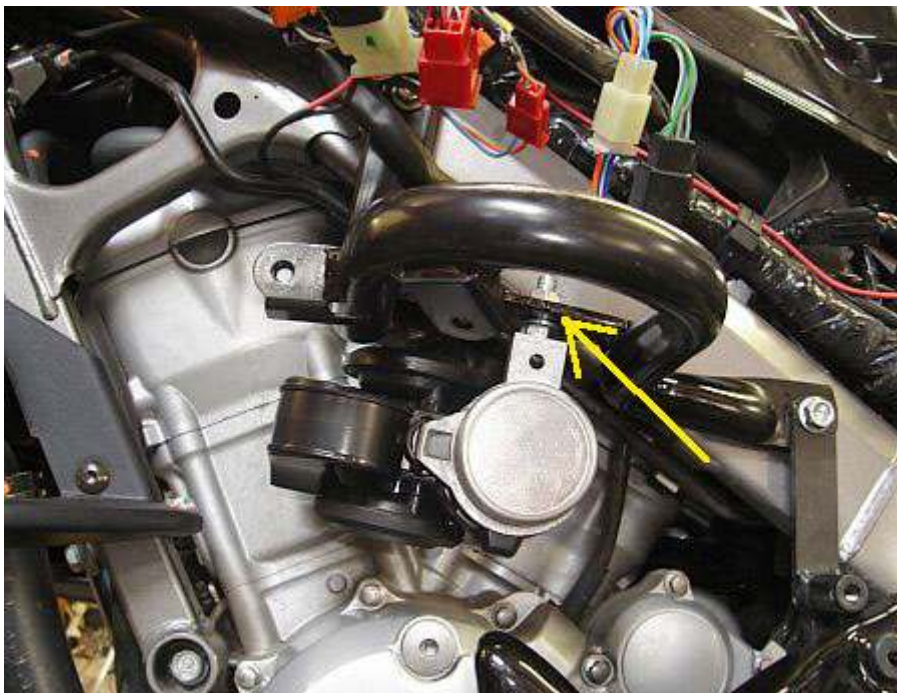
De metalen strip gelast en de Stebel Nautilus gemonteerd.
