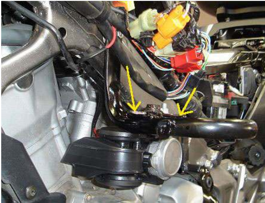
De metalen strip gelast en de Stebel Nautilus gemonteerd.
